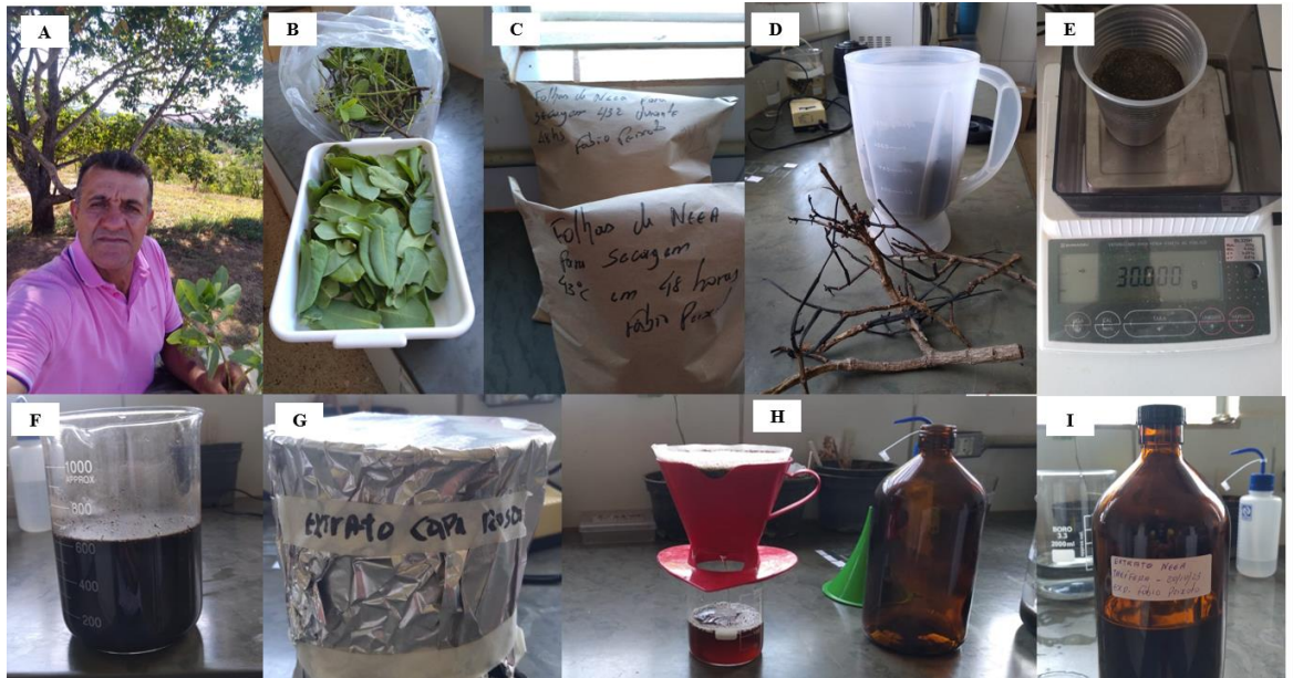
Figura 4.2 - Preparo do extrato aquoso de folhas de capa-rosa. A: Coleta de material de Neea theifera no cerrado do Morro da Catraca em Morrinhos, GO. B: Material vegetal de capa-rosa-do-campo coletado. C: Preparo para secagem do material vegetal. D: Trituração do material vegetal seco. E: Aferição da massa do material para preparação do extrato. F: Mistura do material vegetal com água destilada. G: Descanso do extrato por 24 horas. H: Extrato coado em filtro de papel. I. Extrato aquoso finalizado
